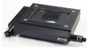
Die Kreuztische der KT-Baugruppe eignen sich besonders für die Anwendung in der messenden Mikroskopie. Durch die offene Bauweise können die Messobjekte auch im Durchlicht betrachtet werden. Eine weitere Anwendung der offenen Tische ist die Dickenmessung von flachen Bauteilen, z. B. Wafern, mit zwei gegenüberliegend angeordneten Sensoren. Die Kreuztische der KT-Baureihe sind im Verfahr Bereich von 50 x 50 bis 420 x 300 mm verfügbar.
