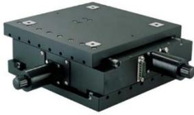
Die Kreuztische der GT-Baugruppe wurde speziell für den Einsatz in der Oberflächen-messtechnik entwickelt. Durch das kompakte Design, sowie die Verwendung ausgesuchter Kreuzrollenführungen und geschliffener Kugelgewindespindeln werden höchste Anforderungen an Ablaufgenauigkeit und Rauschen erreicht. Die Kreuztische der GT-Baureihe sind im Verfahr Bereich von 50 x 50 bis 350 x 350 mm verfügbar.
